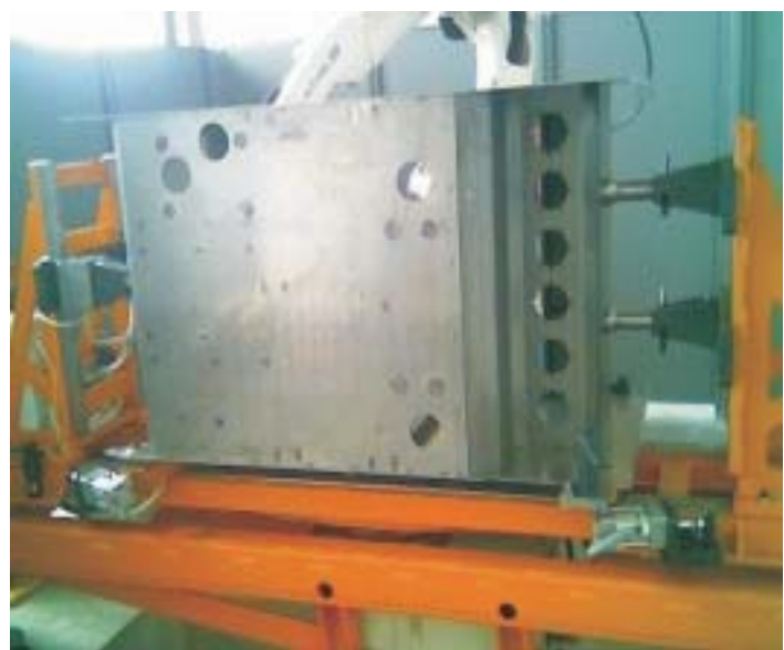
Kombinirana pnevmatsko/mehanska vpenjalna priprava
